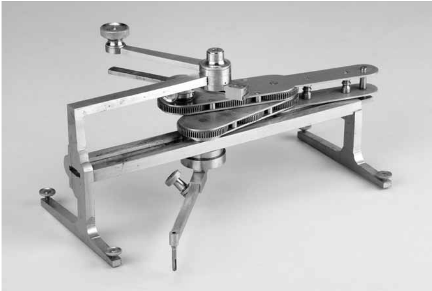
Die Abbildung zeigt einen typischen Bustow'schen Ellipsografen, der nach 1873 in der Fabrik von William Ford Stanley hergestellt wurde.
